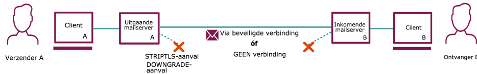
Figuur 4. E-mailverkeer met gebruik van TLS, STARTTLS en DANE
